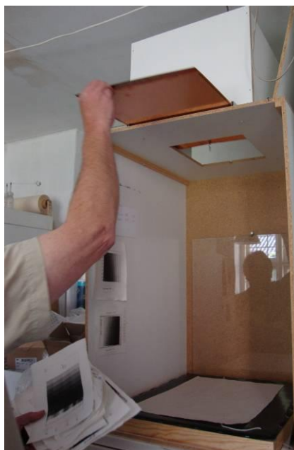
Figura 6: Cabine de luz para gravação do filme fotopolímero (Ateliê de Henrik Boegh em Copenhagen, Dinamarca)
